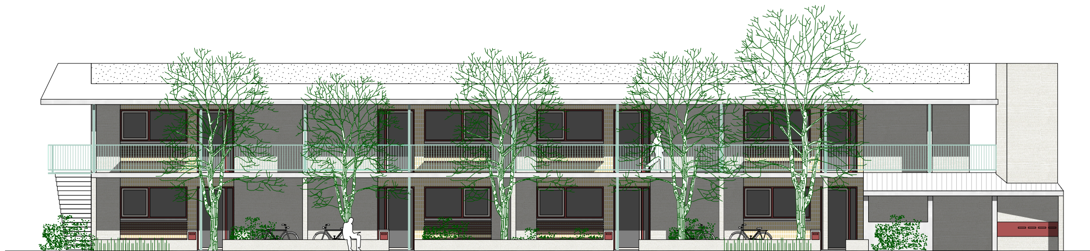
Noordgevel koetsgebouw: een ingetogen gebouw in de schaduw van de luifel, met de voortuinen, galerij, gedeelde fietsenstalling en brievenbussen, en de liftkoker die als schoorsteen het volume beëindigt.
