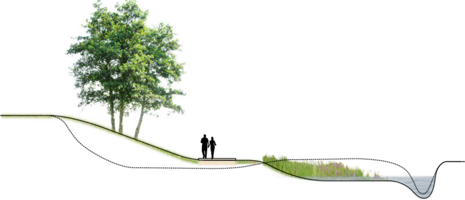
RUIMTELIJK CONCEPT BEEKDAL doorsnede genomen over de Spierebeek verstevigde taluds ingeplant met Notelaar als overgang naar de private kavels van de bewoners van de Sint-Amandswijk
