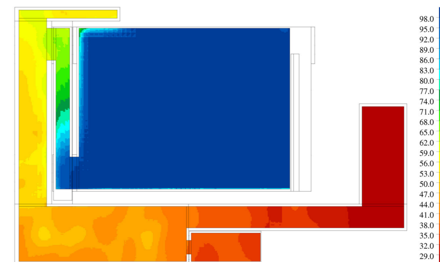
Door de geluidabsorptie in deze chicane wordt het geluid, zonder gebruik te maken van deuren, tot een aanvaardbaar niveau teruggebracht.
