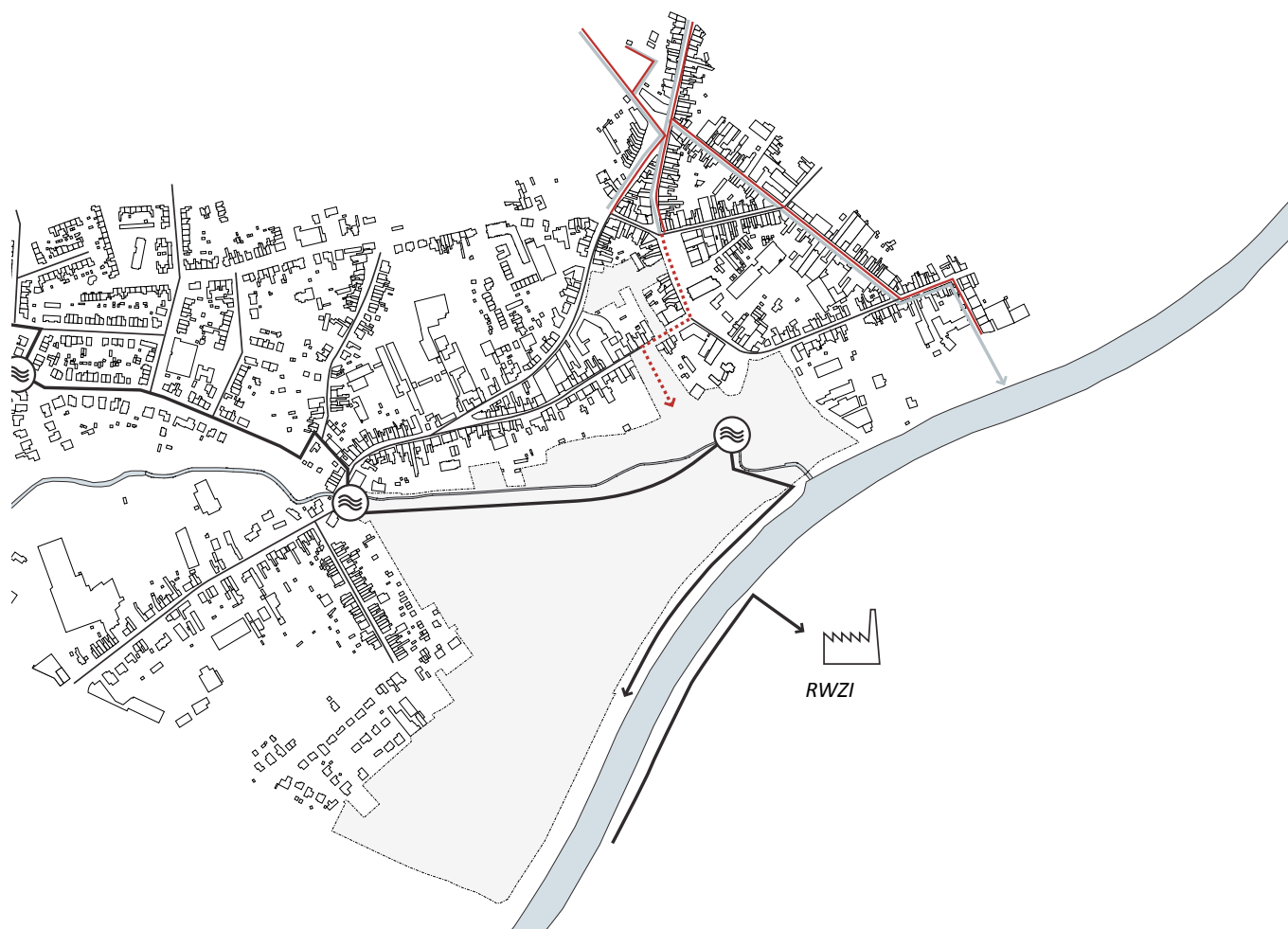
Afkoppeling nieuw rioleringsysteem richting zuiverend park
