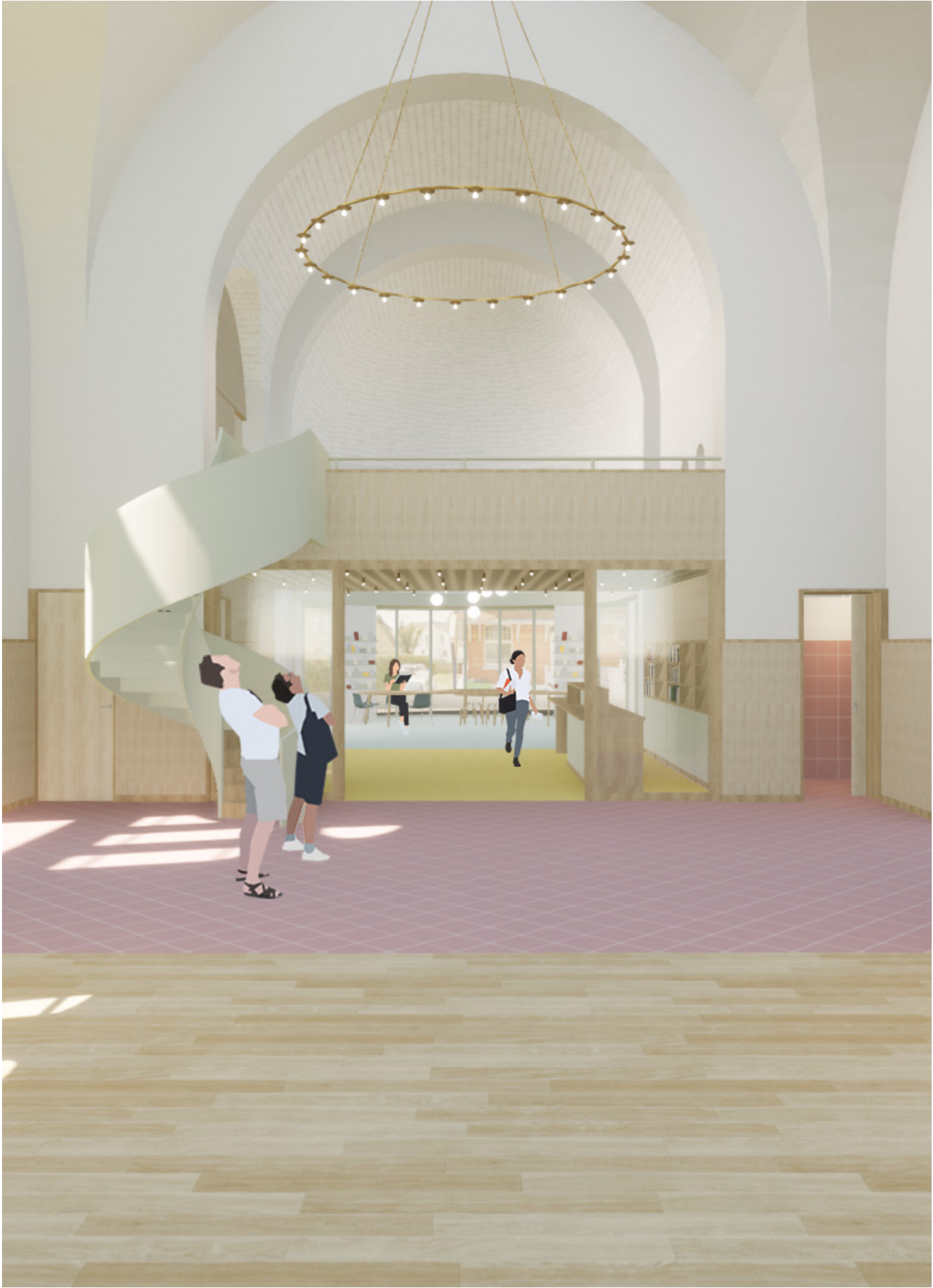
Het interieur ondergaat door de herbesteming een gedaanteverandering. De oorspronkelijk vrij donkere en gesloten kapel verandert door enkele precieze interventies in een open, uitnodigend en multifunctioneel bruikbaar onthaal. Toevoegingen zoals een mezzanine, lambriseringen en nieuwe raamopeningen zorgen voor licht, sfeer, uitzicht en een goede akoestiek.
